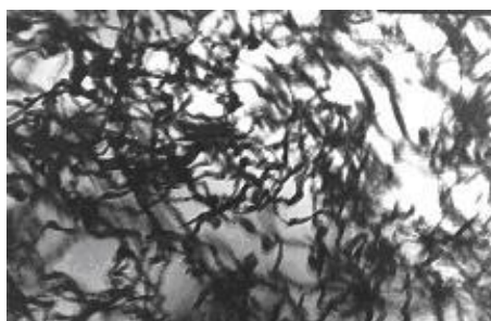
2-р зураг. Атом хүчний микроскопоор ажигласан C-S-H-ийн нанобүтэц
